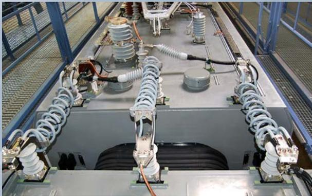
Una forma particolare di sistemi di passaggi intercomunicanti è rappresentata dalle giunzioni elettriche ad alta tensione di LEONI. Questi sistemi di cavi altamente flessibili compensano in maniera costante le oscillazioni e le variazioni di spessore fino a  $\pm 1000$  mm. E offrono anche un'elevata resistenza all'idrolisi, ottime proprietà di rimbalzo a temperature comprese tra i  $-40$  °C e i  $+60$  °C e un'elevata resistenza ai raggi UV.
